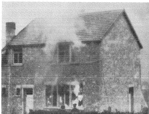
Fig.6 Hus nr.2 (vægge af træfiberplader dækket med brandbeskyttende beklædning) 24 minutter efter forsøgets påbegyndelse. Sandsynligvis endnu mulighed for redning af personer fra 1'sal.
